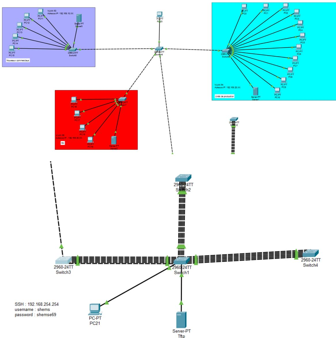
Pour la partie topologie, nous avons réalisé une configuration sur **Packet Tracer** afin d'intégrer un **nouveau LAN** à l'infrastructure existante. Sur l'image de la topologie, nous pouvons observer la configuration complète, incluant à la fois la baie initiale et le nouveau LAN ajouté.
